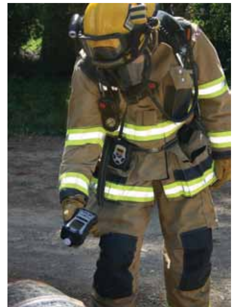
MultiRAE Pro avec une radio maillée RAELink3 utilisée pour détecter les fûts potentiellement dangereux
