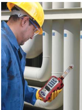
MultiRAE Benzene utilisé pour la détection de fuites
